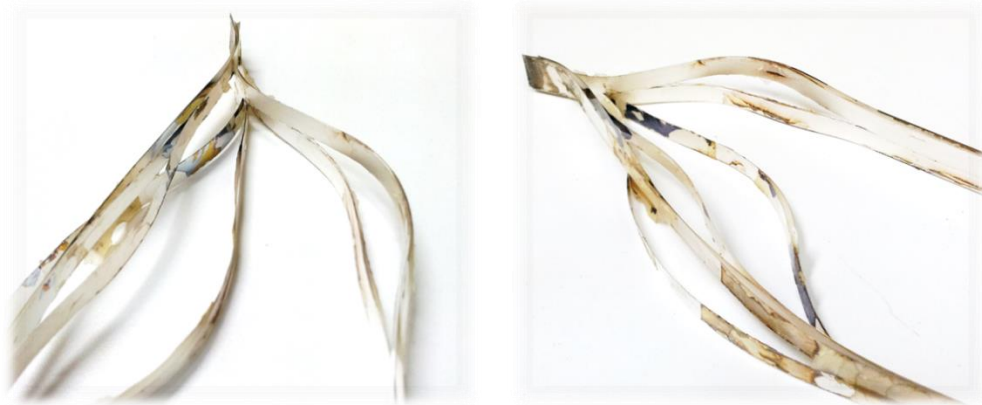
Figura A.5. Resultado ruim do teste de impregnação com resina para aplicações criogênicas.
