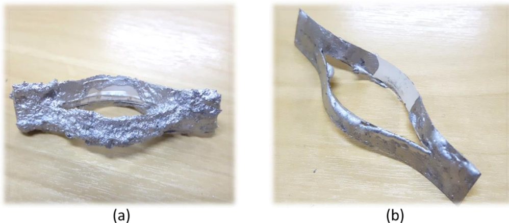
Figura A.6. Testes de impregnação com metal de Wood: imersão em banho de metal (a) e aplicação com soprador de ar quente (b)
