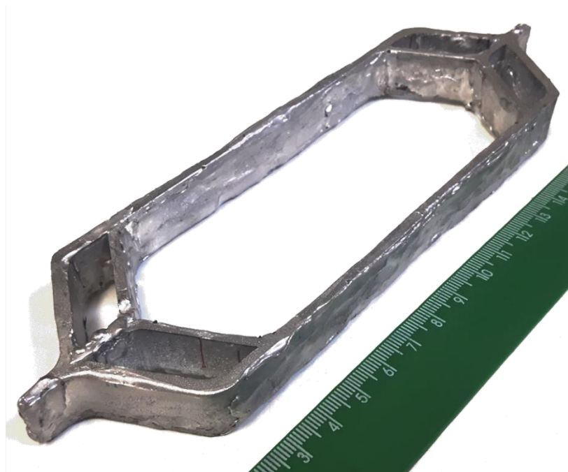
Figura A.8. Bobina LDC feita no 2º molde depois dos defeitos da impregnação serem recobertos manualmente com auxílio de um ferro de solda.
