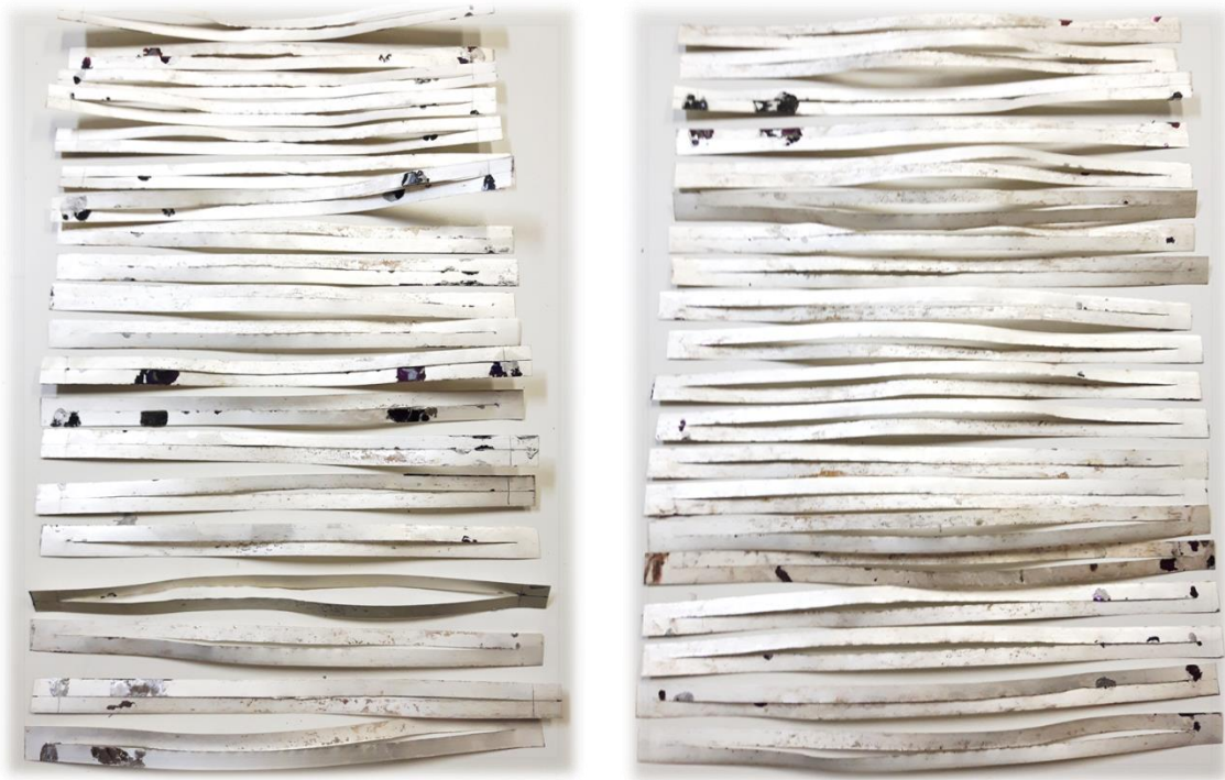
Figura A.10. Laços da bobina degradada desmontada com vários pontos de delaminação.
