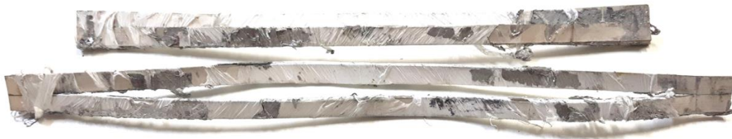
Figura A.9. Laços interno e externo de uma bobina degradada após retirar a impregnação.
