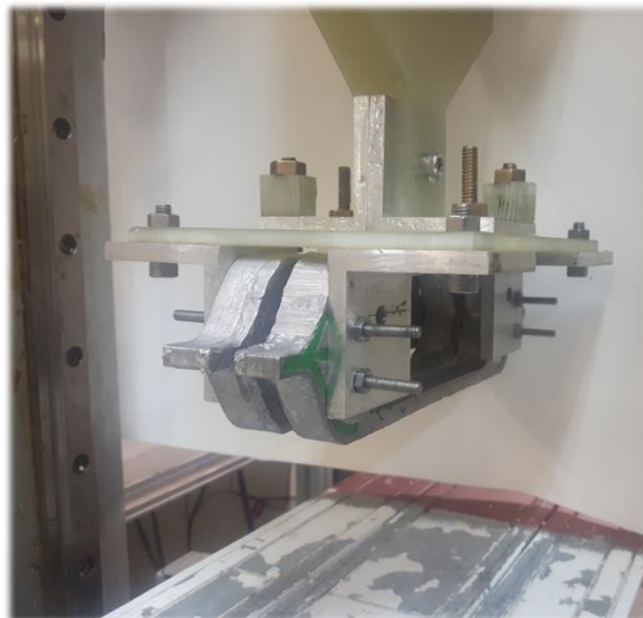
Figura 5.32. Posicionamento das bobinas em relação ao trilho de ímãs permanentes para os testes de força números 15 a 17.
