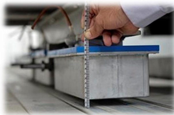
Figura 3.3. Criostato instalado no Maglev Cobra em levitação sobre o trilho de ímãs permanentes.
